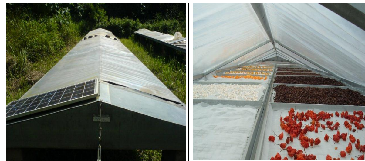
Figure 3 : Séchoir tunnel du type Hohenheim avec vue à l'intérieur
