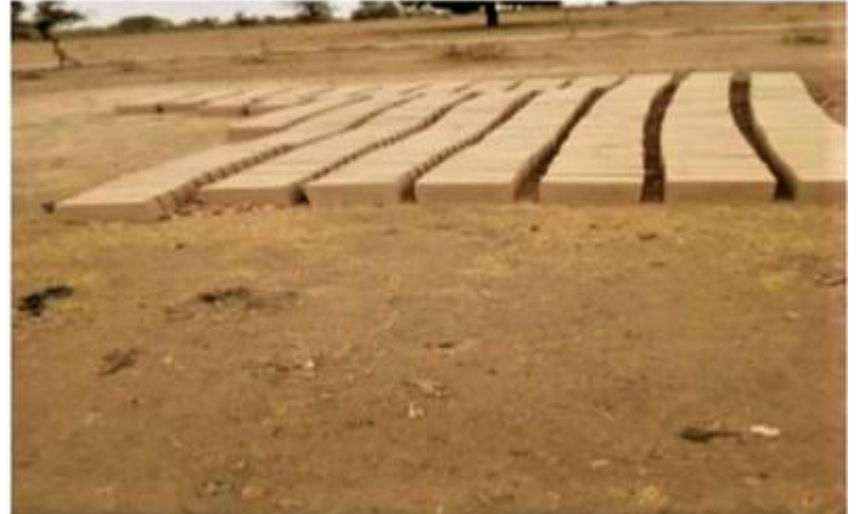
Aménagement effectué par débours avant d'utiliser le tacteur Briques pleines de 15 pour les soubassements de la clôture et des magasins
